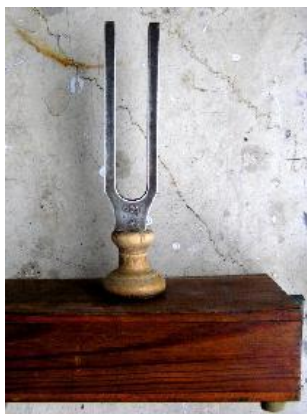
Rys.6. Kamerton wytwarzający ton a' ( f=435\text{Hz} ). Są to metalowe widelki umieszczone na pudle rezonansowym. Dźwięk wzbudzany jest przez uderzenie specjalnym młotkiem
