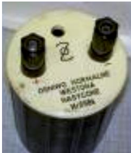
Ogniwo normalne Westona nasycone. Otwór w obudowie służy do umieszczenia termometru
