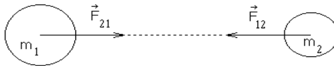
Rys.1. Siły grawitacji w układzie dwóch ciał.
